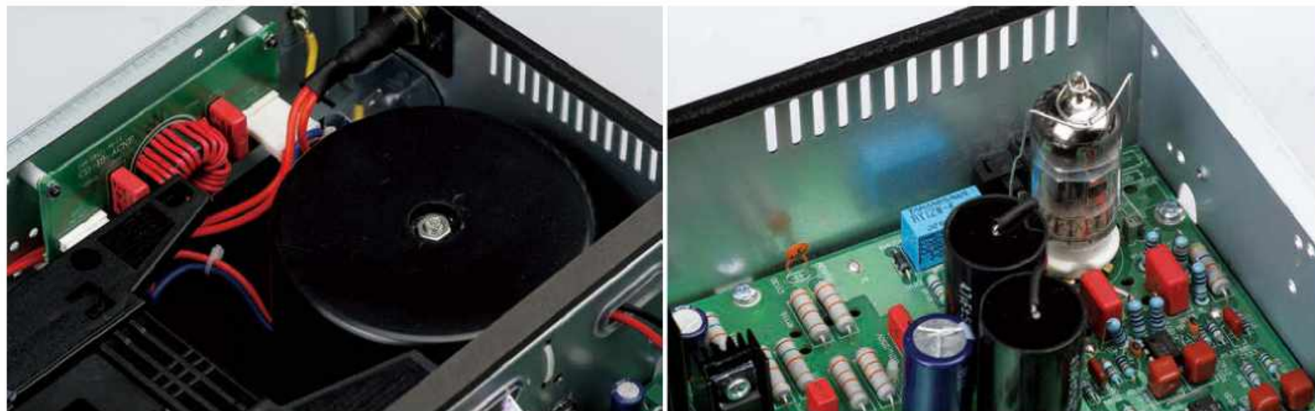
▲左：以平價入門CD唱盤而言，Lativ CD-100的電源供應實在是豐沛無比。 右下：輸出端採用一只12AX7雙三極管，並串以兩組大型交連電容。
